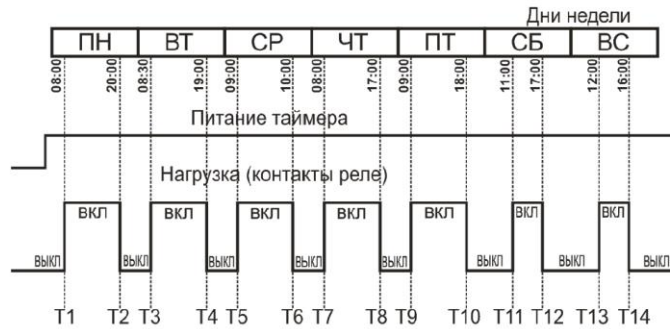
Рисунок 3.4 – Включение нагрузки на примере недельного режима работы
